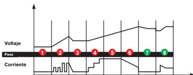
Paso 1 Diagnóstico - Verificar si la batería está conectada al cargador y medir el voltaje de la batería.
