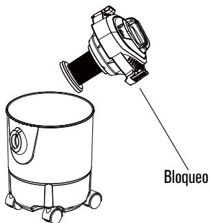
Suelte el bloqueo de bloqueo para abrir la carcasa superior
